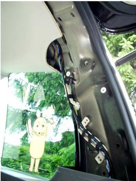
Nun können wir die C-Säulen Verkleidung entfernen, diese ist durch eine Schraube fixiert die sich hinter dem Airbagschild befindet. Dazu hebeln wir vorsichtig mittels eines kleinen Schraubendrehers oder des Teppichmessers das Schild ab. Dann kommen wir an die dahinter befindliche Schraube. Die Verkleidung lässt sich ebenfalls am oberen Ende am besten lösen.
