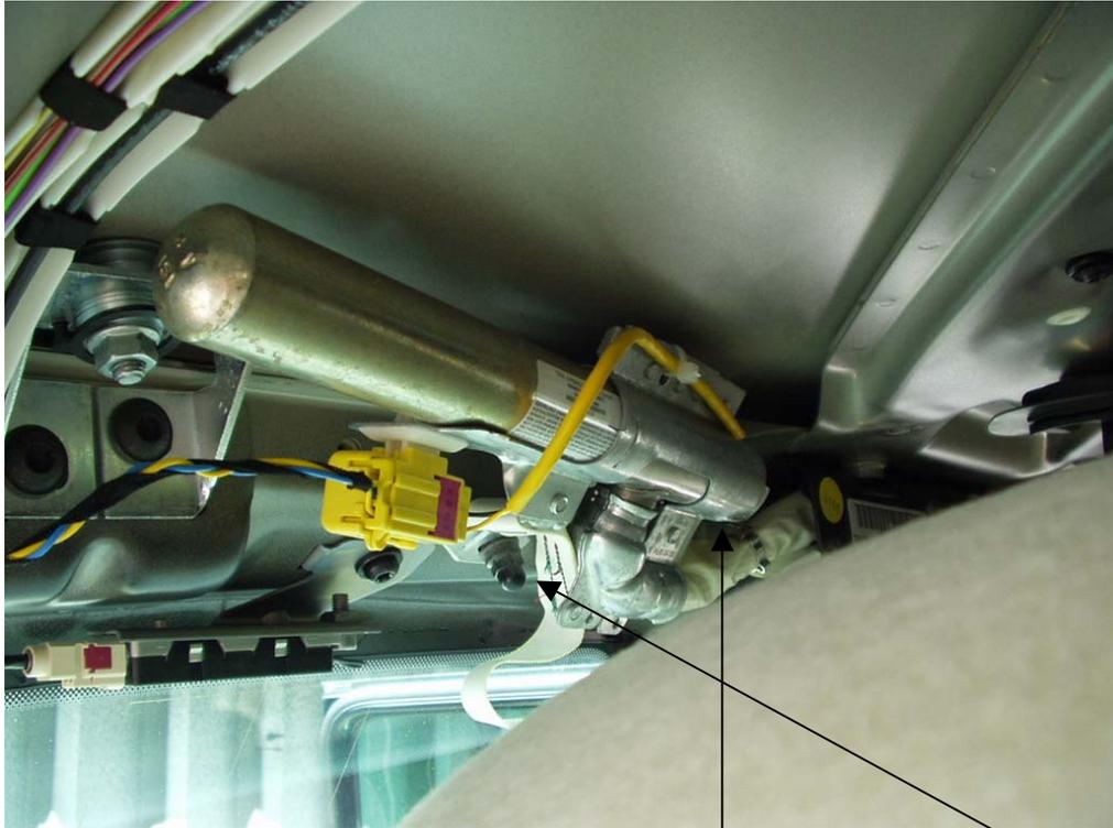
Das ist der Zündsatz der Airbageinheit, hier M6 muss abgeschraubt werden.
