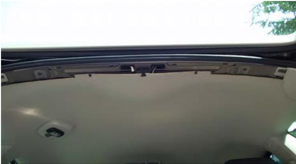
Danach werden die beiden D-Säulen Verkleidungen entfernt, diese sind geclipst und lassen sich recht gut oberhalb langsam ablösen.
