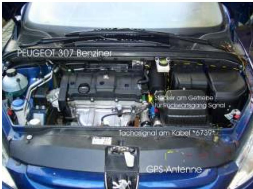
Das berühmte Kabel \*6739\* gibt es auch an anderen Stellen im Motorraum. Hier wie auf den weiteren Fotos ist auch der Abgriff des Rückfahrsignals und eine Positionierung für einen GPS-Empfänger enthalten. Anmerkung von mir: die GPS-Antenne halte ich dort für schlecht platziert wegen der Abschirmung durch die Aluminium-Motorhaube.
