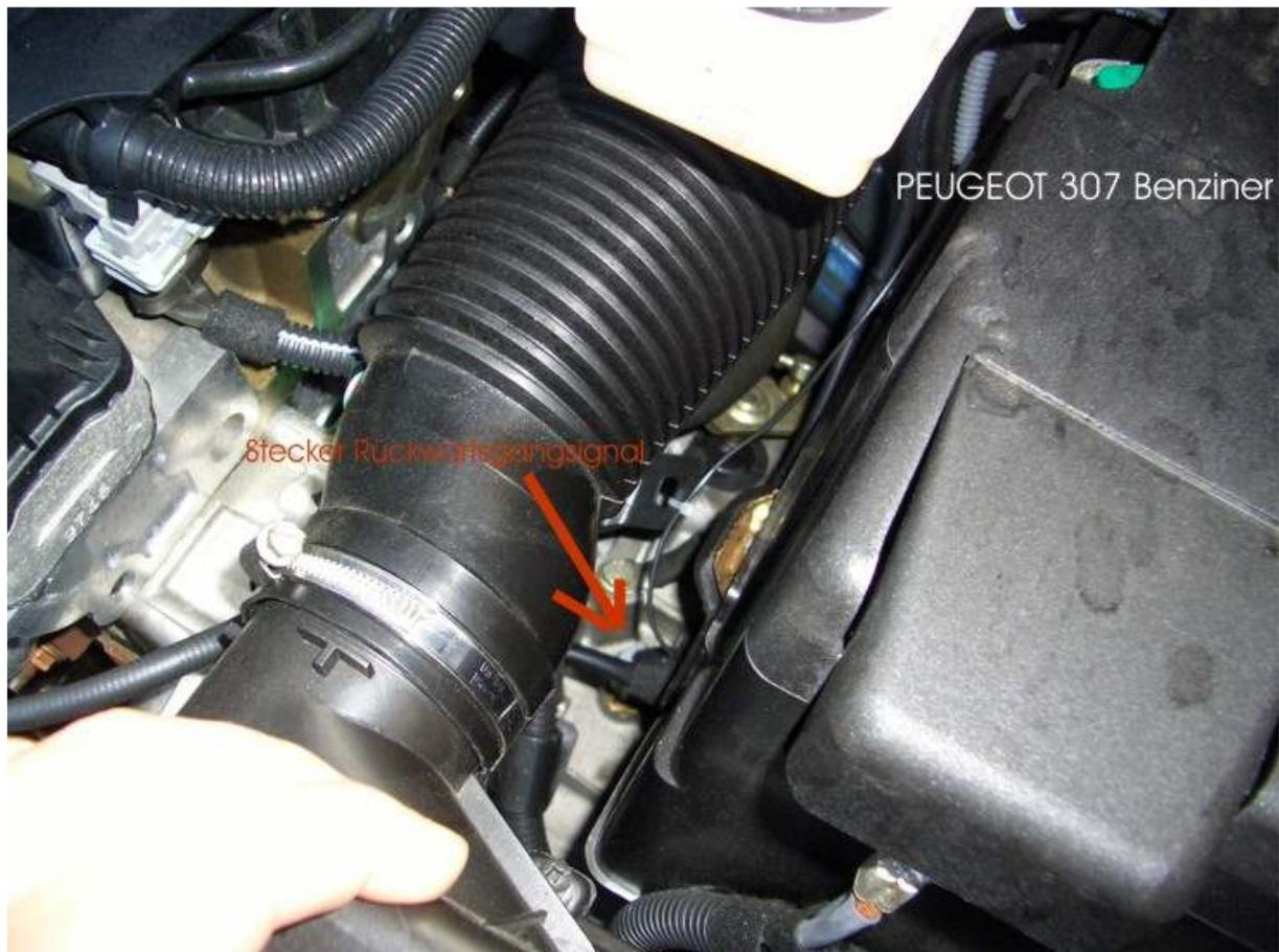
Gut versteckt am Getriebe, ziemlich genau senkrecht 20 cm nach unten zwischen Batteriekasten und Luftschlauch (nach dem Motorluftfilter) befindet sich der Stecker für das Rückwärtsgangsignal. Genaue Daten sind nicht bekannt, dürften aber von jedem mit Hilfe eines Messgerätes zu finden sein.
