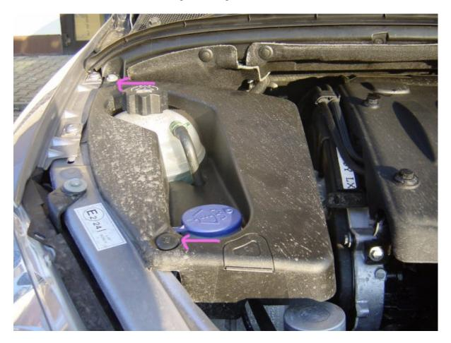
Um an den Kabelbaum mit dem Tachosignal ranzukommen, musst Du die oben gezeigte Verkleidung abmontieren. Die mit den Pfeilen markierten Plastik - Stifte bekommst Du am besten raus, wenn Du den mittleren Stift reindrückst und das Ganze dann rausziehest.
