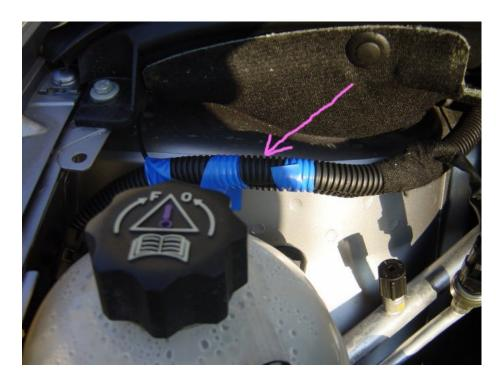
Im Bild ist der Kabelbaum markiert. Dieser ist schon passend aufgeschlitzt. Darin befinden sich ca. 20-30 verschiedene Kabel. Suche nach einem **grün-braunen** Kabel mit dem Aufdruck 6739. Die Zahlen stehen dabei untereinander und sind daher nicht so einfach zu entziffern. Nun an einer Stelle das Kabel mit einem Messer ca. 1cm abisolieren und daran das Kabel für das Tachosignal am besten anlöten. Das Ganze nun gut abisolieren.
